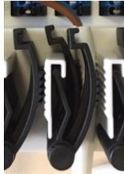
Les serre-câbles conviennent pour les câbles flexibles avec un diamètre de gaine de 5 mm à 8 mm, principalement en utilisant le serre-câbles inférieur (voir illustration). Vérifiez que les câbles sont bien en place. Les câbles pleins, plus épais et plus fins doivent toujours être placés fermement et doivent être fixés du côté de l'installation.
