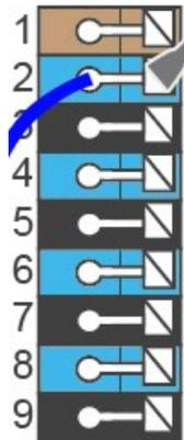
Les fils ou câbles massifs munis d'embouts spéciaux peuvent être simplement enfoncés dans les bornes. Pour les autres fils, il faut d'abord **appuyer complètement** sur la truelle avec un tournevis, comme indiqué.
