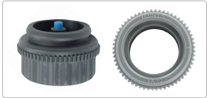
Adaptateur de servomoteurs M (pour collecteur laiton) 040714 VA 04 M 30 x 1 pour collecteur 1" 040716 VA 10 M 30 x 1,5 pour collecteur 5/4"
