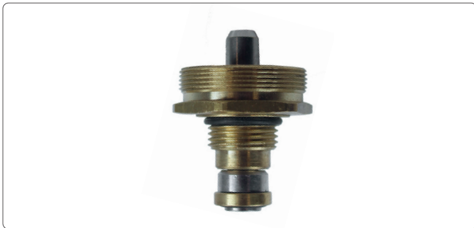
Insert de régulation thermostatique M (Collecteur en laiton 1") 040713 Insert pour le collecteur du retour diam. ext. 3/8" pour servomoteur M 30 x 1"
